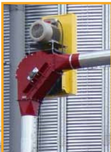
HNACÍ KOLENO S MOTOREM A PŘEVODOVKOU DODGE
