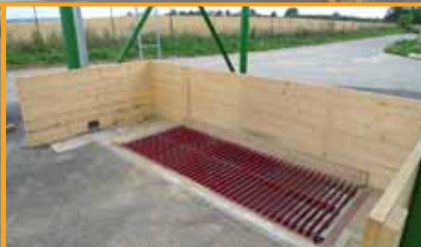
INTEGROVANÁ PŘÍJMOVÁ NÁSYPKA S PŘEJEZDNÝM ROŠTEM V RŮZNÝCH DÉLKÁCH
