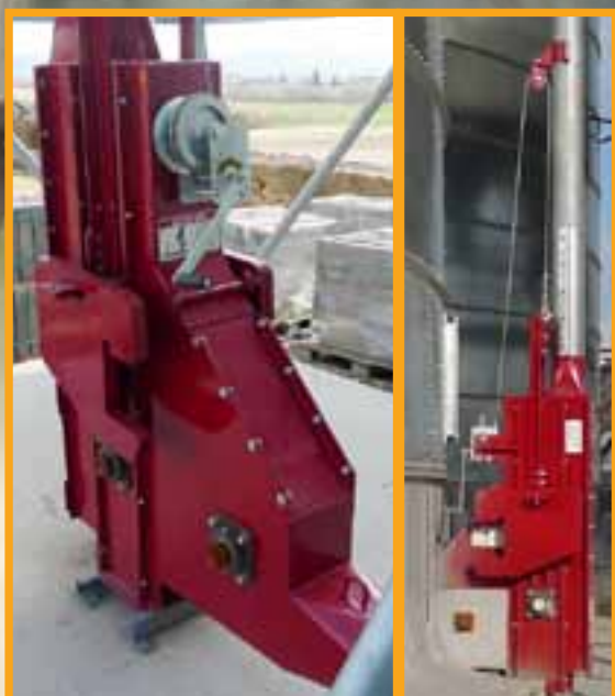
KOLENO S AUTOMATICKÝM NAPÍNACÍM SYSTÉMEM A SERVISNÍM VSTUPEM
