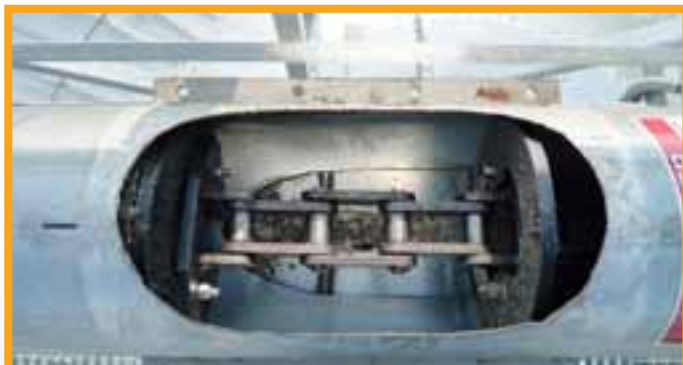
SILNOSTĚNNÉ POTRUBÍ S ROBUSTNÍM ŘETĚZEM A PLASTOVÝMI UNÁŠEČI
